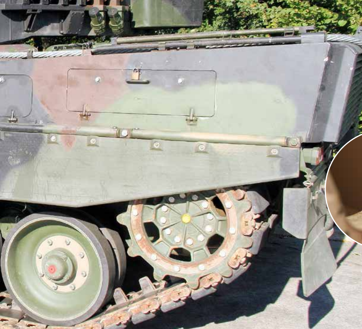
15 jaar geleden: een tandkrans van een Nederlandse Leopard 2A6 waarvan de slijtage is 'opgevuld' met behulp van 'laser cladding' bij het LAC in Twente.
