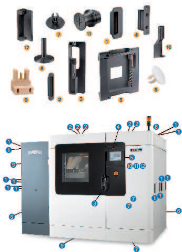
Het Amerikaanse Statasys maakt met zijn machines nieuwe machines. Hier zijn de onderdelen afgebeeld van de FDM 900mc machine voor rapid manufacturing, die met FDM zijn gerealiseerd.
