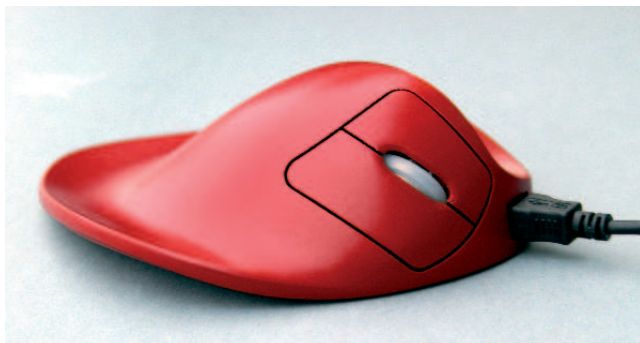
De met SLS verkregen behuizing van de ergonomisch gevormde muis van Hippus.
