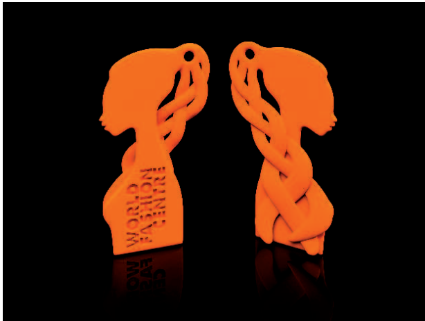
Het Amsterdamse Freedom of Creation liet een kleine serie sleutelhangers maken voor het Wold Fashion Centre. Selective laser sintering staat het vervaardigen van kleine series toe. Let op de niet-lossende vorm (nodig in het geval van spuitgieten).
